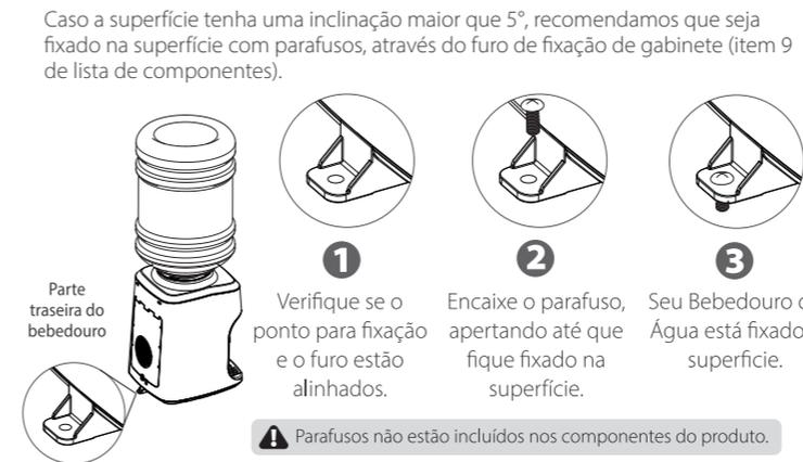
Caso a superfície tenha uma inclinação maior que 5°, recomendamos que seja fixado na superfície com parafusos, através do furo de fixação de gabinete (item 9 de lista de componentes).
