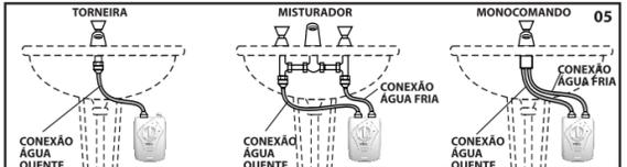
Conexão do Aquecedor à torneira (Fig.:05):
