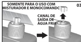
• O Aquecedor Versátil permite a instalação direta com torneira, misturador e monocomando (Fig.:05).
