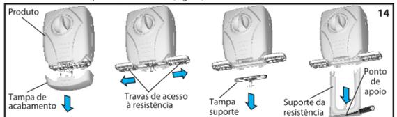
• Insira o novo suporte da resistência no produto. Identifique pelo lado interno da tampa, a posição da área de encaixe, a qual deverá coincidir com a área de encaixe do suporte. Feito isso, certifique-se de que o anel de vedação esteja devidamente alojado na borda da tampa do suporte e encaixe-o no produto. Se necessário, lubrifique o anel para facilitar a montagem. Esta tampa deve estar bem encaixada para evitar vazamentos (Fig.:15). Desloque as travas de acesso fechando-as (Fig.:15).
