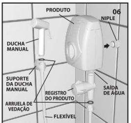
Fixação do suporte da ducha manual: Fixe o suporte a uma altura adequada para o alcance das mãos e também no sentido de facilitar o fluxo da água pelo flexível, tomando o cuidado para não perfurar o encanamento que se encontra embutido na parede.
