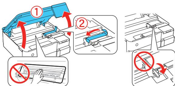
**Cuidado:** Não toque nas áreas indicadas dentro do produto. A impressora é despachada com a trava de transporte na posição de impressão. Não tire a trava de transporte da posição de impressão.
