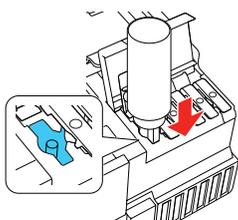
**Observação:** Não force as garrafas no lugar; elas são projetadas para que se encaixem em suas cores específicas.
