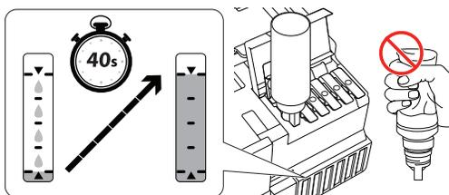
**Observação:** A tinta corre para dentro do tanque e para automaticamente quando o tanque fica cheio até a linha superior. Se a tinta não correr da garrafa, remova e insira a garrafa novamente.
